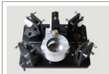
Die neuartige Multireflexionszelle: eine Entwicklung der Forschungsstelle für Atmosphärische Chemie der Universität Bayreuth. Der innere Durchmesser der Zelle beträgt 6 cm. Foto: Chr. Wißler, zur Veröffentlichung frei.
